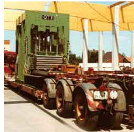
1988: Anlieferung einer Mehretagen-Durchlaufpresse der Firma OTT unter anderem für die Fertigung von Echtholzpaneelen.
